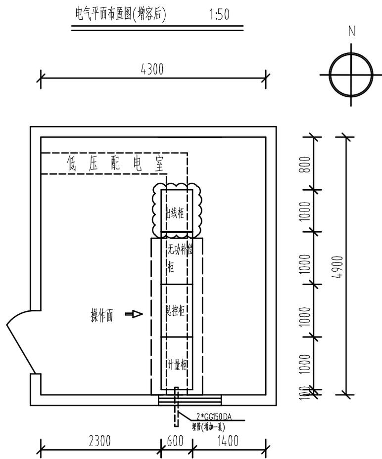
说明:1、本变电所原有3台低压柜,柜型为GGD,其中计量柜1台、总控兼出线柜1台、无功补偿柜1台;本期对低压柜的改造如下:
