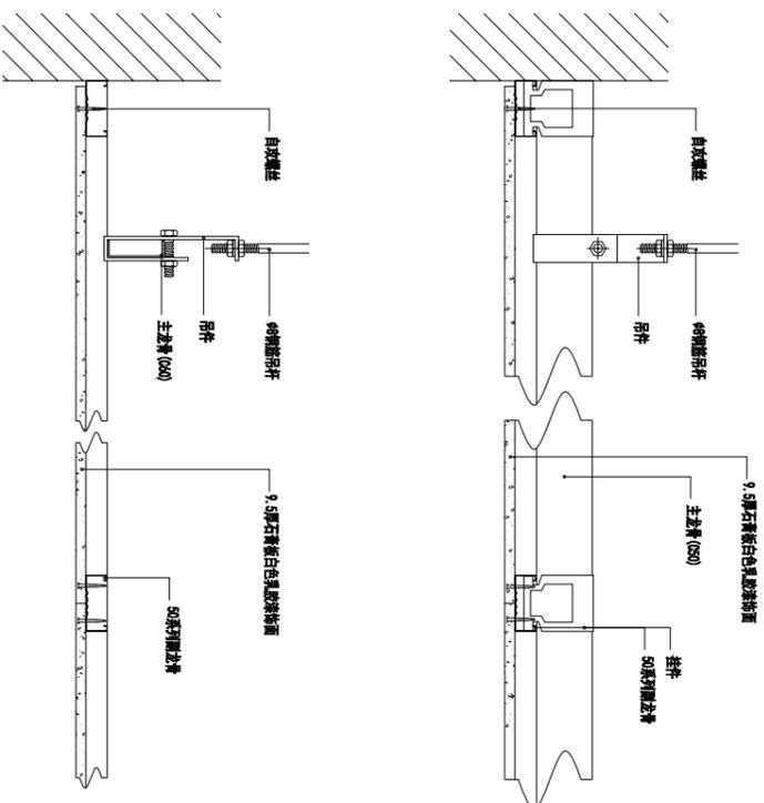
吊顶1 石膏板吊顶乳胶漆饰面示意图
