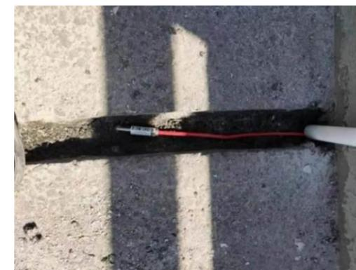
图 6.5-3 桥面温度传感器
