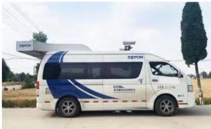
图 3-1RTM 智能道路检测车
